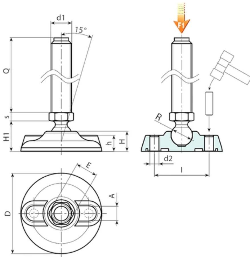
**Версия P911: Опора со стержнем типа А(с шестигранником) и шаровой головкой 12,4**
