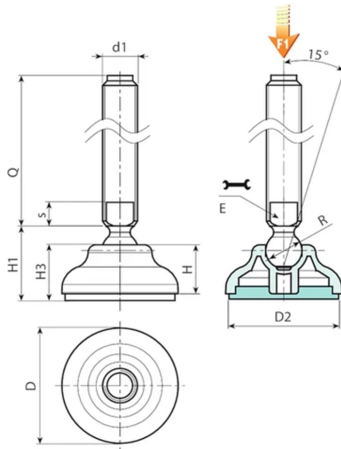
**Версия P910: Опора со стержнем типа В (с фрезерованной лыской под ключ) и шаровой головкой 15-противоскользящее основание из термопластичной резины SBS**
