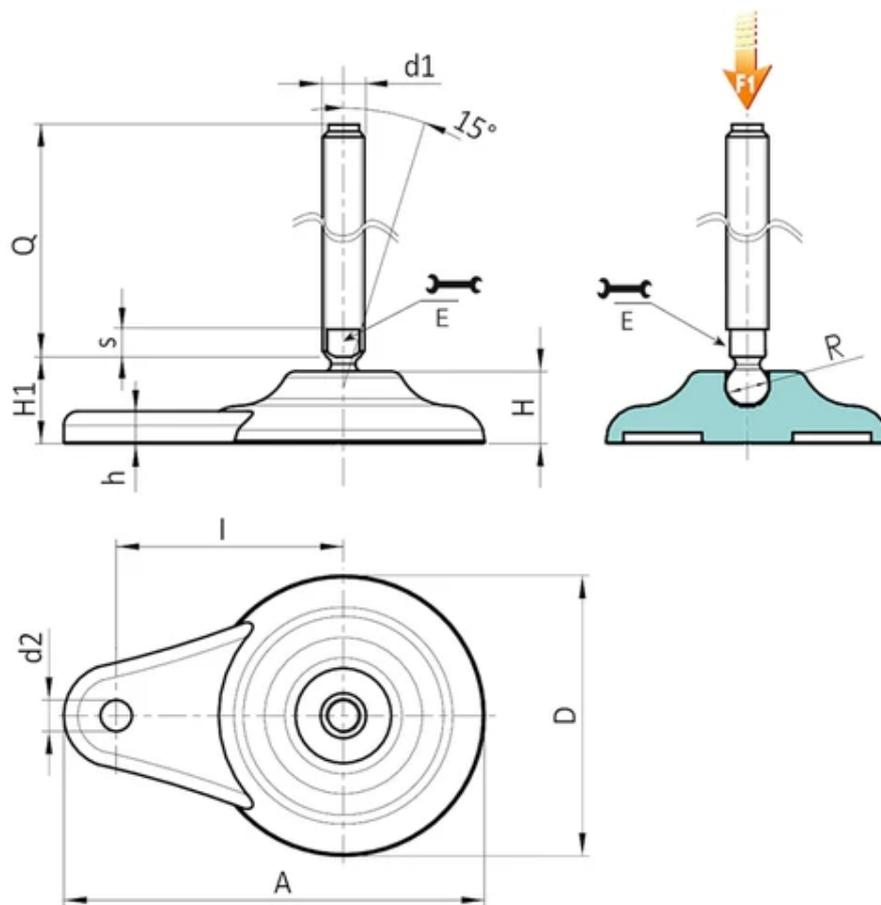
**Versão P708: Pé de apoio com fixação lateral, perno tipo B (alojamento para chave fresado) e esfera 24**
