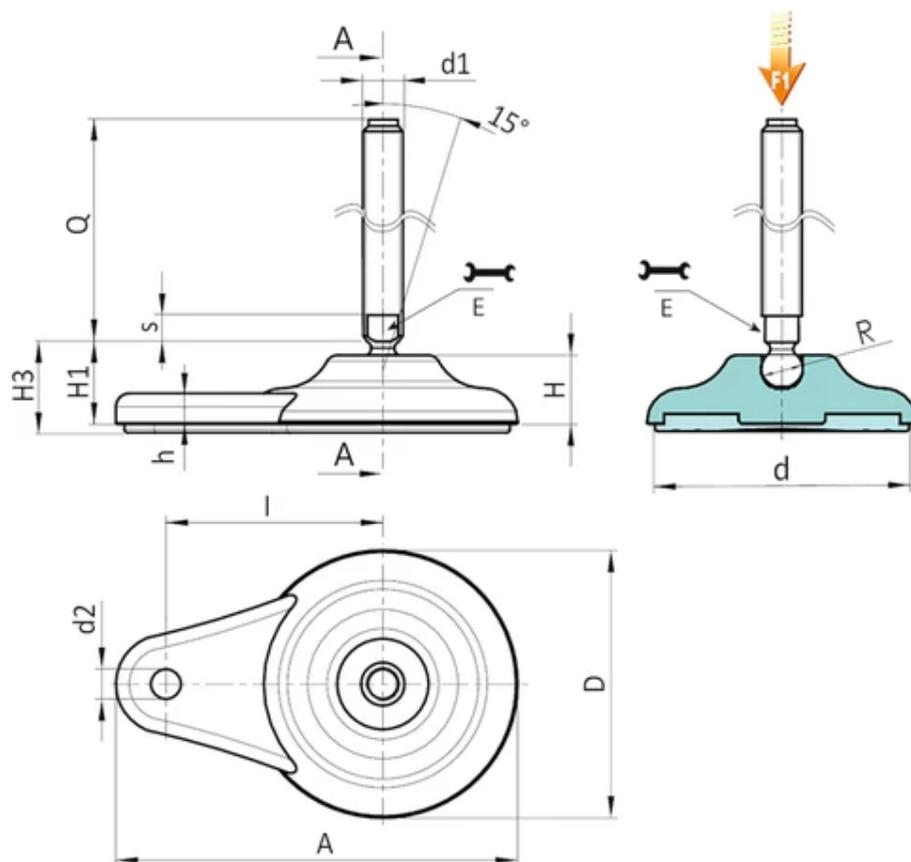
**Versão P705: Pé de apoio com fixação lateral, perno tipo B (alojamento para chave fresado) e esfera 12,5 - com antiderrapante em SBS**
