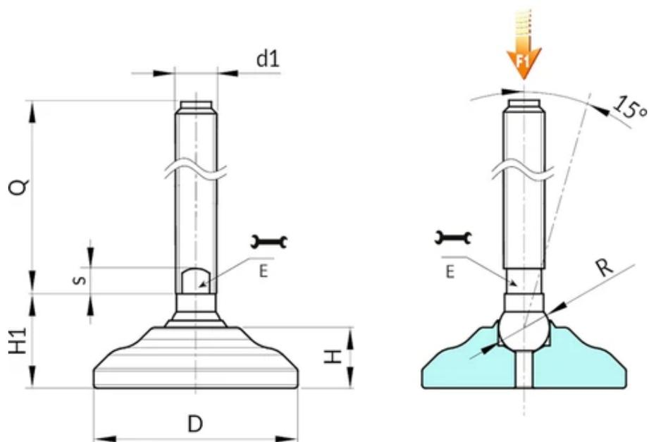
**Versão P532: Pé de apoio em aço zincado, perno tipo B (alojamento para chave fresado) e esfera 12.5**
