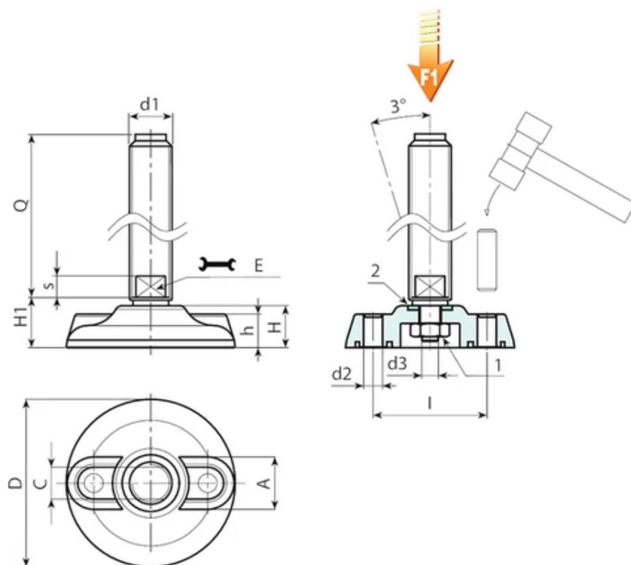
**Versione P800: Piede di appoggio con stelo girevole con fissaggio tramite dado**
