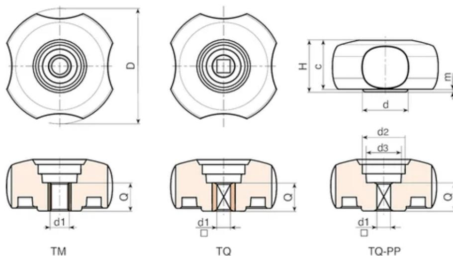
**Version Q283 TM: Avec insert en laiton et trou fileté passant.**
