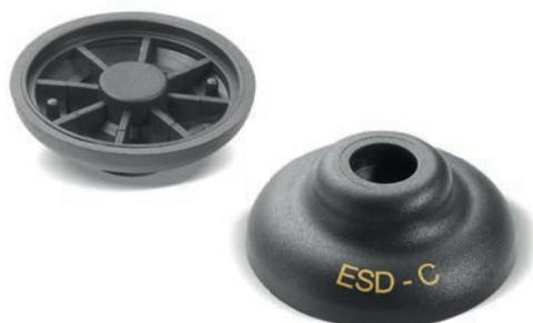
Remarques: Cet article est fabriqué avec un additif ESD-C (Electro Static Discharge - Conductive) selon la norme EN 100015/1 et IEC 61340-5-1. Le produit est conducteur et empêche la formation de décharges électrostatiques en facilitant son passage à la terre. La tampographie « ESD - C » de couleur jaune facilite son identification. Produit adapté aux lignes de production de matériel électronique et à l'utilisation dans des atmosphères explosives.
