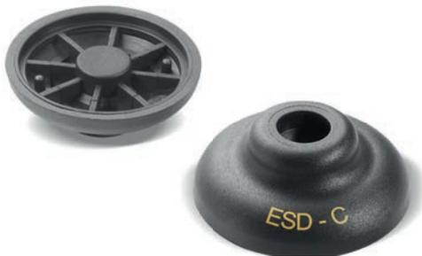
Notas: Este artículo está producido con material aditivado ESD-C (Electro Static Discharge - Conductive), conforme a las normas EN 100015/1 e IEC 61340-5-1. El producto es conductor y previene la formación de descargas electrostáticas, facilitando su descarga a tierra. Una tampografía de color amarillo (ESD-C) facilita su identificación. Producto apto para líneas de producción de material electrónico y para uso en atmósferas explosivas.
