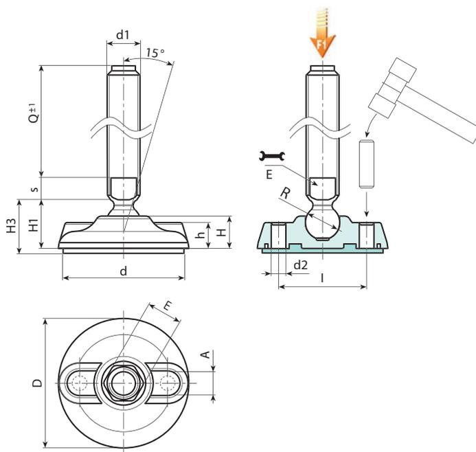
Версия P916: Опора со стержнем типа В (с фрезерованной лыской под ключ) и шаровой головкой 12,4 - противоскользящее основание из термопластичной резины SBS
