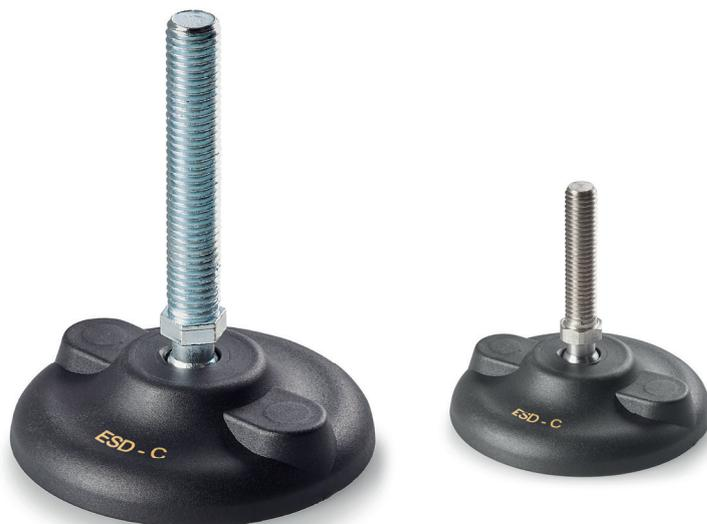
Note: Questo articolo è prodotto con materiale additivato ESD-C (Electro Static Discharge - Conductive) secondo la norma EN 100015/1 e IEC 61340-5-1. Il prodotto risulta conduttivo e previene la formazione di scariche elettrostatiche facilitandone il passaggio a terra. Una tampografia in colore giallo (ESD-C) aiuta la sua identificazione. Prodotto adatto per linee di produzione di materiale elettronico e per uso su atmosfere esplosive.
