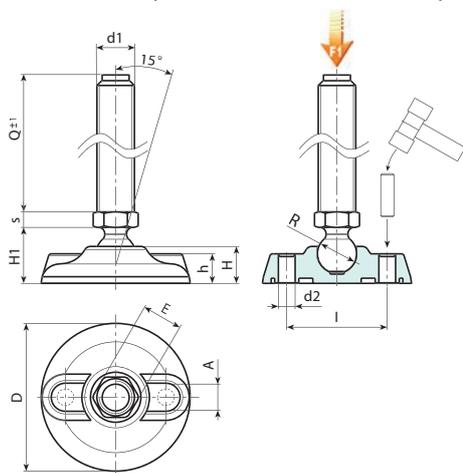
Версия P911: Опора со стержнем типа А (с шестигранником) и шаровой головкой 12,4
