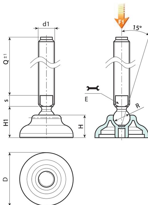
Версия P907: Опора со стержнем типа В (с фрезерованной лыской под ключ) и шаровой головкой 15
