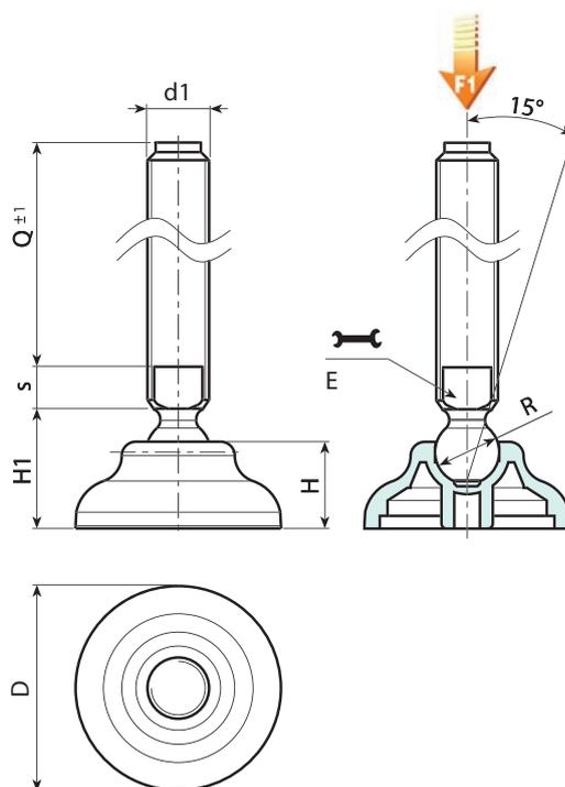
Version P907 : Pied d'appui avec tige de type B (logement pour clé fraisée) et bille 15
