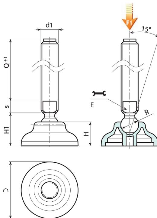
Version P906 : Pied d'appui avec tige de type B (logement pour clé fraisée) et bille 12,4
