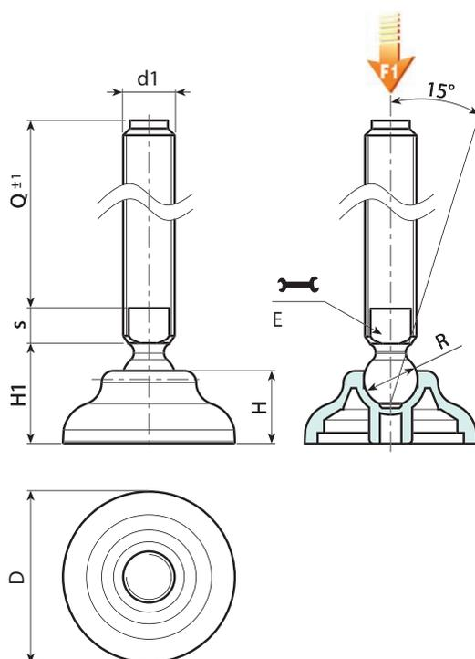
Ausführung P906: Gelenkfuß mit Verstellspindel Typ B (Aufnahme für Gabelschlüssel) und Kugel 12,4
