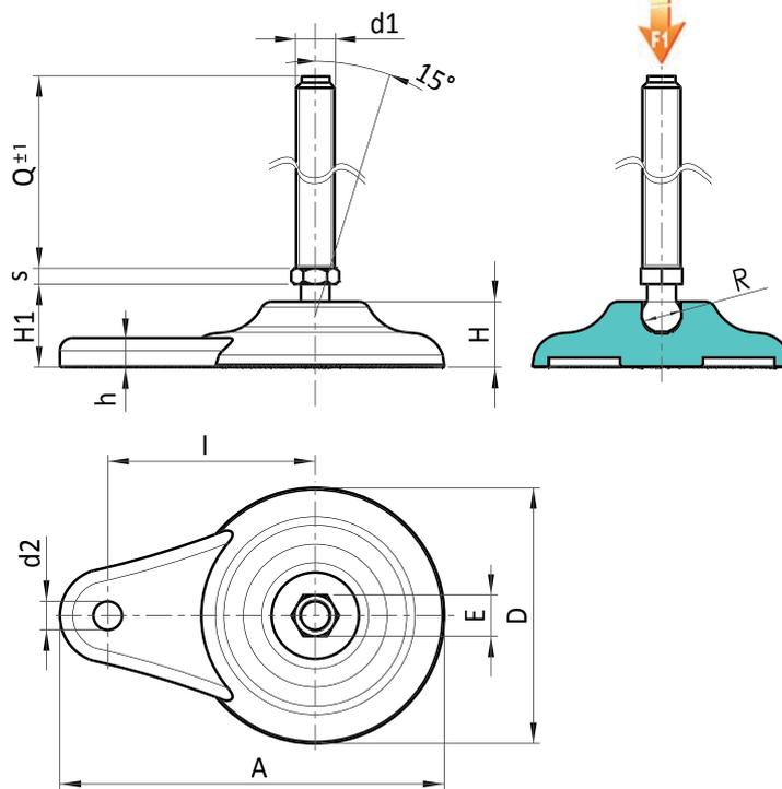
Version P702CIN : Pied d'appui avec fixation latérale, tige de type A en acier inox (avec hexagone) et bille 15
