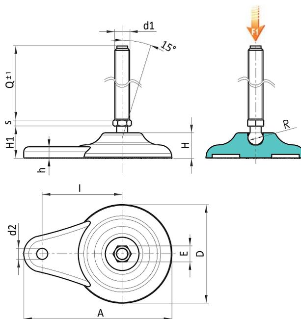
Version P702 : Pied d'appui avec fixation latérale, tige de type A (avec hexagone) et bille 15
