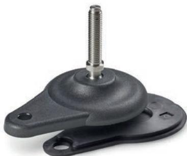
Версия P701: Опора с боковым креплением, со стержнем типа А (с шестигранником) и шаровой головкой 12,5 - противоскользящее основание из термопластичной резины SBS.
