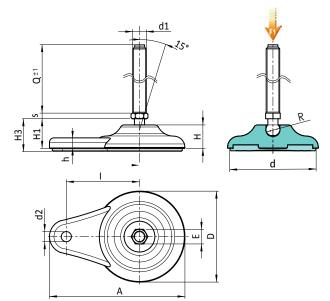
Versione P701: Piede di appoggio fiss. laterale con stelo tipo A (con esagono) e sfera 12,5 - con antiscivolo in SBS
