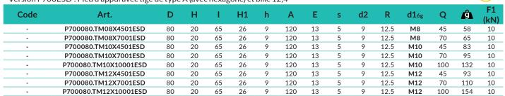
Attention : La limite de charge F1 exprimée est inférieure de 30 % à la charge de rupture et elle est considérée une valeur statique. Longueurs pivot sur demande avec un minimum de 100 pièces.
