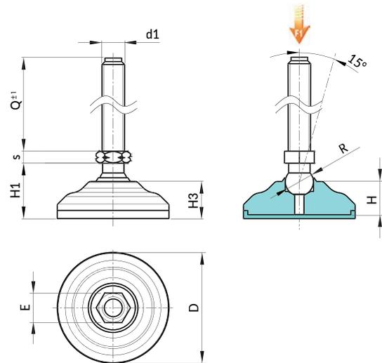
Ausführung P544: Gelenkfuß aus verzinktem Stahl mit Verstellspindel Typ A (mit Sechskant) und Kugel 24 - mit rutschfester Gummiauflage aus SBS
