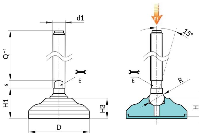
Version P542 : Pied d'appui en acier zingué avec tige de type B (logement pour clé fraisé), bille 12,5 et base antidérapante en SBS
