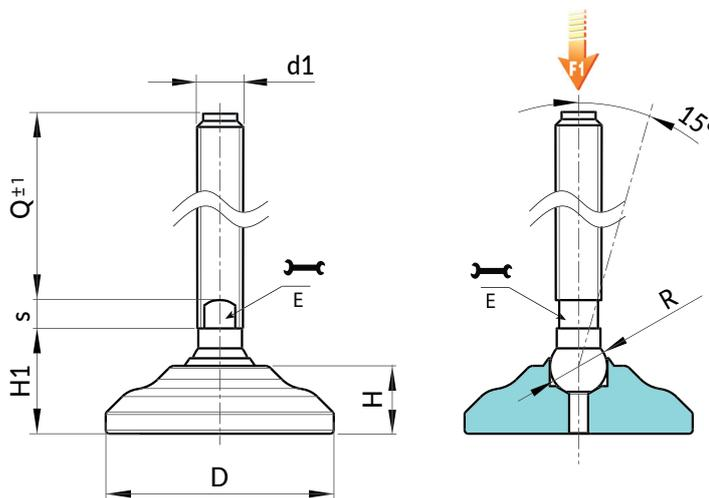
Versione P532: Piede di appoggio in acciaio zincato con stelo tipo B (sede chiave fresata) e sfera 12.5
