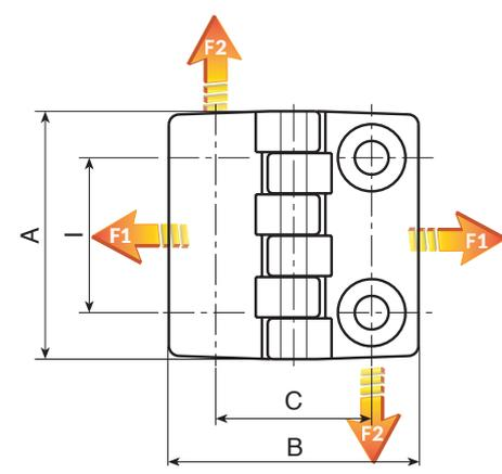
Версия O434-TS: отверстия под винт с потайной головкой
