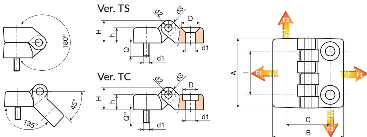
Version O434-TS : avec trous pour vis à tête fraisée
