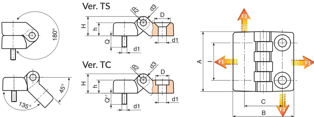
Ausführung O434-TS: mit Löchern für Senkschrauben
