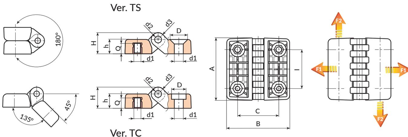
Версия O433-TS: отверстия под винт с потайной головкой
