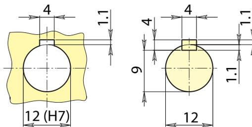
Réalisation clavette surbaissée conformément à la norme DIN 6885-2
