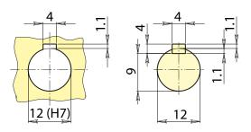
Ausführung flache Passfeder nach der Norm DIN 6885-2
