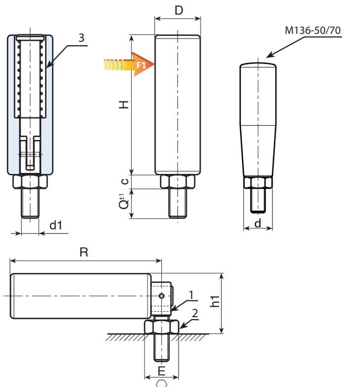
Ausführung M136: Ausführung aus brüniertem Stahl.
