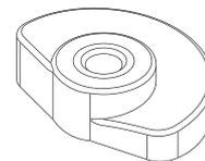
Cette came doit être associée à tout volant avec pivot. De cette manière (voir le croquis ci-contre), l'ensemble devient une simple serrure pour portes. En tournant le volant, on fait également tourner la came, qui, étant en forme de spirale, modulera l'épaisseur de prise en se fixant sur le battant prévu.
