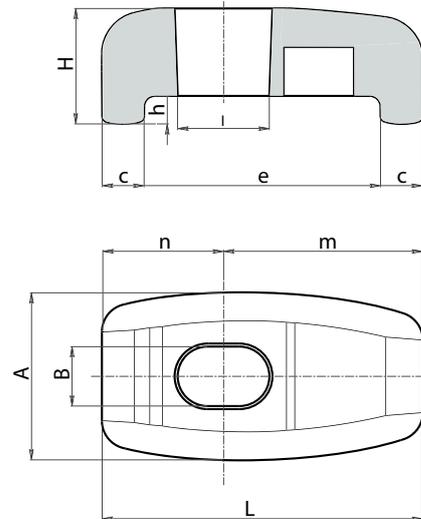
Скоба J300 используется в сочетании с ручкой с резьбовым штырем. Для сочетания подходит, например, Т-образная ручка арт. L271. Устройство в сборе работает как система быстрого заперения для панелей машин вообще. Особенно рекомендовано для фиксации панелей больших наружных чиллеров в системах кондиционирования воздуха.
