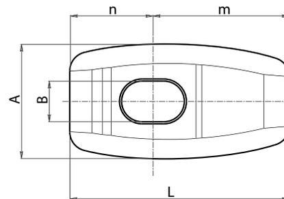
L'utilisation de la bride J300 doit être combinée avec une poignée à pivot fileté. Une combinaison optimale est obtenue avec la poignée en T art. L271. L'ensemble fonctionne comme un système de blocage rapide pour les panneaux de machines en général. Particulièrement adapté aux panneaux isolants des grandes unités de conditionnement extérieures.
