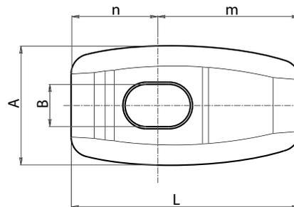
El uso del estribo J300 se debe combinar con el de un botón con perno roscado. Una combinación eficaz puede ser con un tirante Art. L271. Juntos, funcionan como sistema de bloqueo rápido para paneles de máquinas en general. Particularmente indicado para paneles aislantes de grandes unidades enfriadoras exteriores de acondicionamiento.
