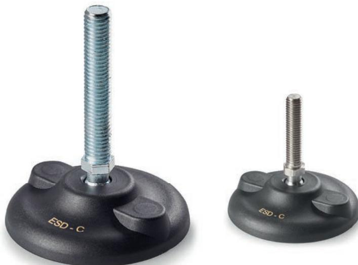
Remarques: Cet article est fabriqué avec un additif ESD-C (Electro Static Discharge - Conductive) selon la norme EN 100015/1 et IEC 61340-5-1. Le produit est conducteur et empêche la formation de décharges électrostatiques en facilitant son passage à la terre. La tampographie « ESD-C » de couleur jaune facilite son identification. Produit adapté aux lignes de production de matériel électronique et à l'utilisation dans des atmosphères explosives.
