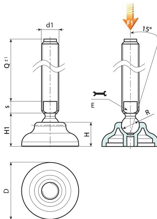
Ausführung P907: Gelenkfuß mit Verstellspindel Typ B (Aufnahme für Gabelschlüssel) und Kugel 15
