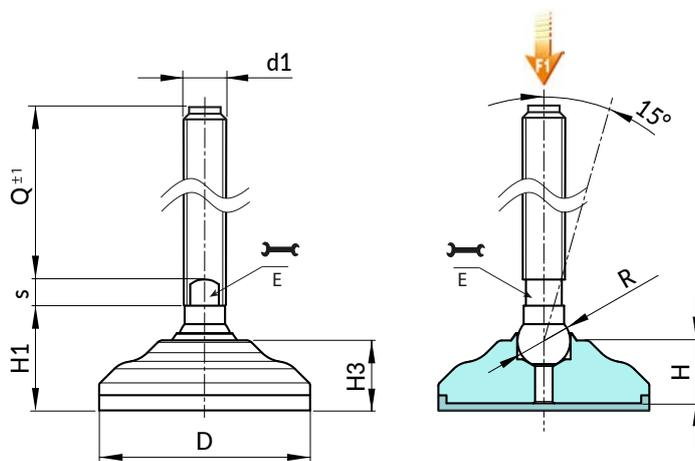
Versione P542: Piede di appoggio in acciaio zincato con stelo tipo B (sede chiave fresata) e sfera 12.5 - con antiscivolo in SBS
