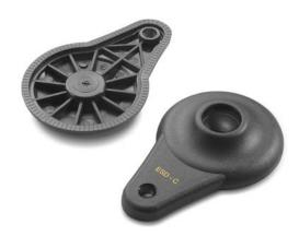
Note: Questo articolo è prodotto con materiale additivato ESD-C (Electro Static Discharge – Conductive) secondo la norma EN 100015/1 e IEC 61340-5-1. Il prodotto risulta conduttivo e previene la formazione di scariche elettrostatiche facilitandone il passaggio a terra. Una tampografia in colore giallo (ESD-C) aiuta la sua identificazione. Prodotto adatto per linee di produzione di materiale elettronico e per uso su atmosfere esplosive.
