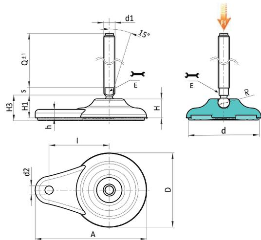
Ausführung P709: Gelenkfuß mit Verstellspindel Typ B - aus PA - (mit Aufnahme für Gabelschlüssel) und Kugel 24 - mit rutschfester Gummiauflage aus SBS
