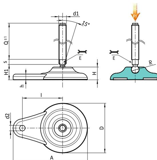
Versione P704: Piede di appoggio fiss. laterale con stelo tipo B (sede chiave fresata) e sfera 12,5
