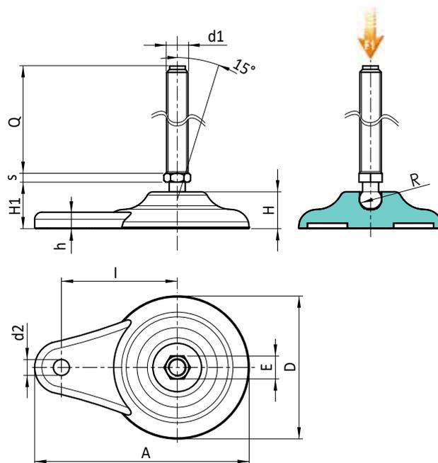
Версия P702: Опора с боковым креплением, со стержнем типа А (с шестигранником) и шаровой головкой R15
