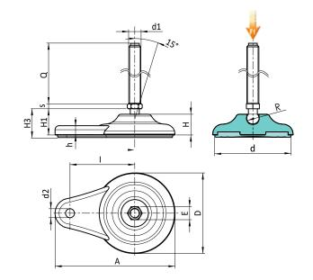
Версия Р701: Опора с боковым креплением, со стержнем типа A (с шестигранником) и шаровой головкой R12,5 - противоскользящее основание из термопластичной резины SBS.
